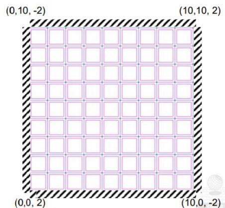
El siguiente análisis se realiza por elementos triangulares, con la formulación de la teoría de Reissner-Mindlin, para elementos tipo placa, en esta se considera 5 grados de libertad, 3 de ellos desplazamientos (X, Y y Z), y 2 giros respecto a los ejes locales X y Y.
