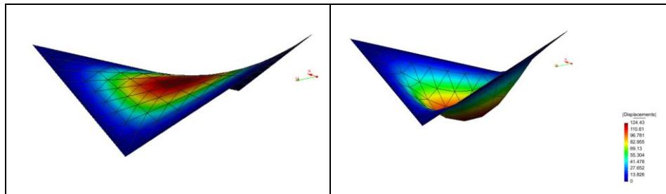
Los resultados de los esfuerzos son simétricos, respecto a ejes locales de la estructura, como se observa en las siguientes gráficas, y se observan coherentes respecto a la respuesta de la carga de peso propio de la estructura. En el caso del Momento XY, y Txy se observa simétrico respecto a un eje entre los puntos extremos (Nodo 91 y 10).
