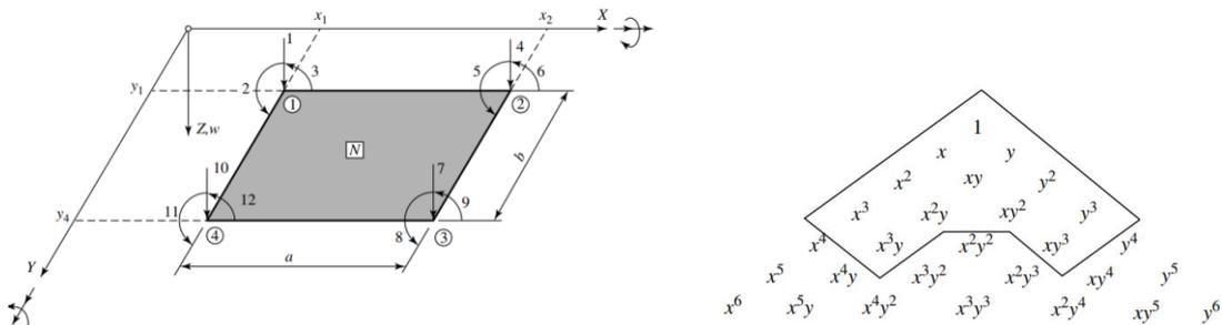
El elemento es no conforme, y existe discontinuidad en ciertos puntos del elemento en los factores de forma, que ocurren en los bordes adyacentes.
