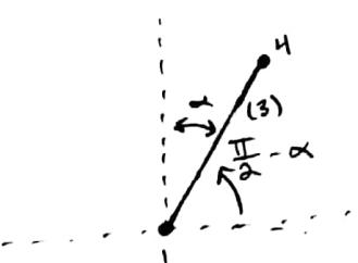
$$K^3 = \frac{EA}{L} \begin{bmatrix} c^2 & sc^2 & -c^2 & -sc^2 \\ sc^2 & c^2 & -sc^2 & -c^2 \\ -c^2 & -sc^2 & c^2 & sc^2 \\ -sc^2 & -c^2 & sc^2 & c^2 \end{bmatrix}$$
