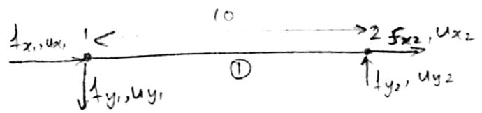
$$\begin{bmatrix} f_{x1}^{\textcircled{1}} \\ f_{y1}^{\textcircled{1}} \\ f_{x2}^{\textcircled{1}} \\ f_{y2}^{\textcircled{1}} \end{bmatrix} = 10_2 \begin{bmatrix} 1 & 0 & -1 & 0 \\ 0 & 0 & 0 & 0 \\ -1 & 0 & 1 & 0 \\ 0 & 0 & 0 & 0 \end{bmatrix} \begin{bmatrix} u_{x1}^{\textcircled{1}} \\ u_{y1}^{\textcircled{1}} \\ u_{x2}^{\textcircled{1}} \\ u_{y2}^{\textcircled{1}} \end{bmatrix} \quad \left( \frac{EA}{L} \right)^{\textcircled{1}} = \frac{100}{10} = 10$$
