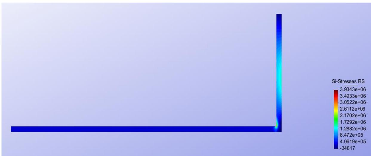
En el caso de las compresiones podemos ver que se originan en la unión entre las paredes y el fondo del cilindro, debido a la concentración de esfuerzos por la unión que se genera.
