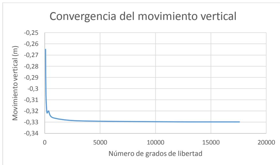
Se observa cómo con triángulos lineales de tamaño 0,2 la solución ha convergido perfectamente. Por lo tanto, para buscar la carga máxima que se puede aplicar a la placa sin que ésta sufra tensiones mayores a 30 MPa se usará esta malla.
