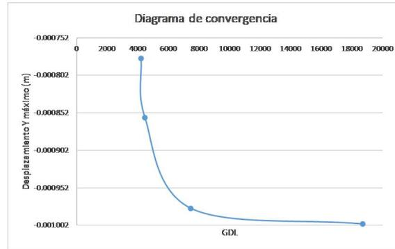
Figura 3.6: Diagrama de convergencia en desplazamientos en el eje  $y$  para elementos tetraédricos de 3 nodos.
