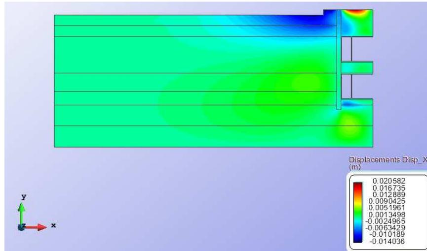
Para asegurar que las condiciones de contorno de simetría se han escogido de manera adecuada, se ha realizado un cálculo adicional con todo el dominio al completo. Observando que la distribución y el valor de las deformaciones es muy parecido y dentro del rango admisible por debajo de los 30 KPa.
