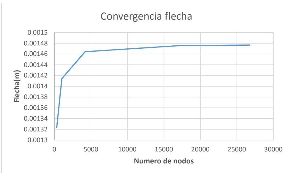
En la gráfica anterior se ve la rápida convergencia de flechas con dicho elemento, a partir de una malla de tamaño 0.3 m la diferencia es mínima, del orden de la centésima de milímetro.
