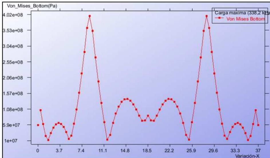
Tal y como se puede ver en el gráfico anterior la tensión máxima obtenida es la de 400MPa que requería el enunciado y, por lo tanto, queda demostrado que la sobrecarga máxima que la cubierta puede soportar sin superar los 400MPa de tensión de Von Mises es la de 338kPa.
