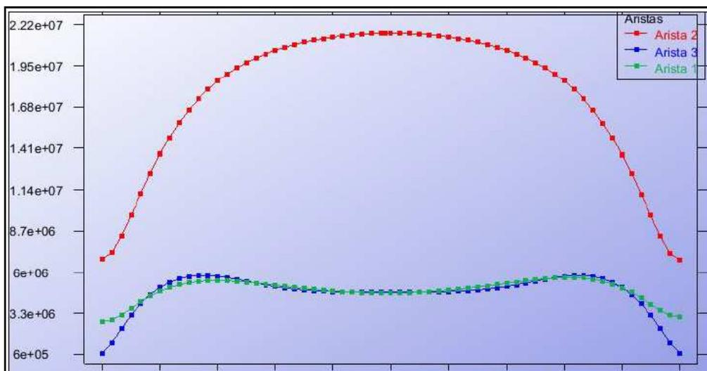
Tal y como se ve, en la arista 2 ocurren las máximas tensiones, confirmando así los resultados obtenidos en el apartado anterior. Esta tensión máxima tiene un valor de casi  $22 \times 10^7$  Pa, es decir, 22MPa. Entonces, para el caso del peso propio se puede confirmar que la tensión máxima es inferior a la restricción del enunciado de 400MPa.
