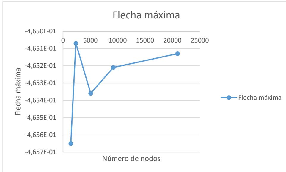
Figura 3 Análisis de convergencia para desplazamiento vertical
