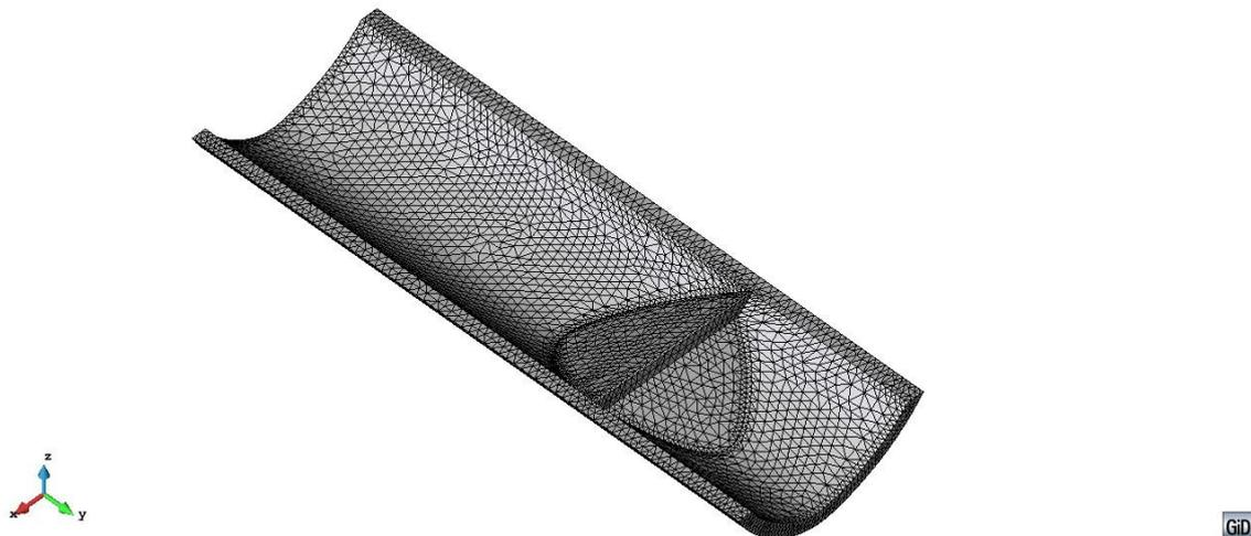
Figura 12. Malla de elementos finitos tetraedros de tamaño 10.
