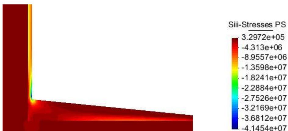
Figura 10. Compresiones máximas con espesor de 8 cm
