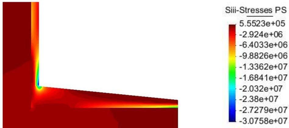
Figura 12. Compresiones máximas con espesor de 20 cm
