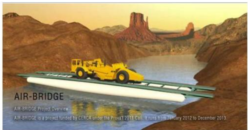
El puente inflable desplegado CIMNE
